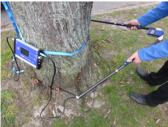
PiCUS Calliper 3 im Einsatz an einer Brandkrustenlinde.
